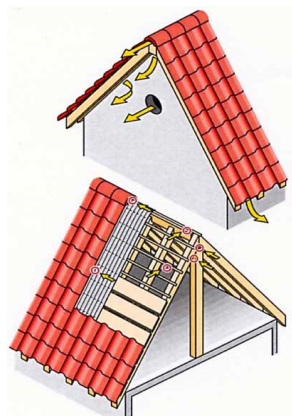
Einflug- und Versteckmöglichkeiten von Fledermäusen an Hausdächern
