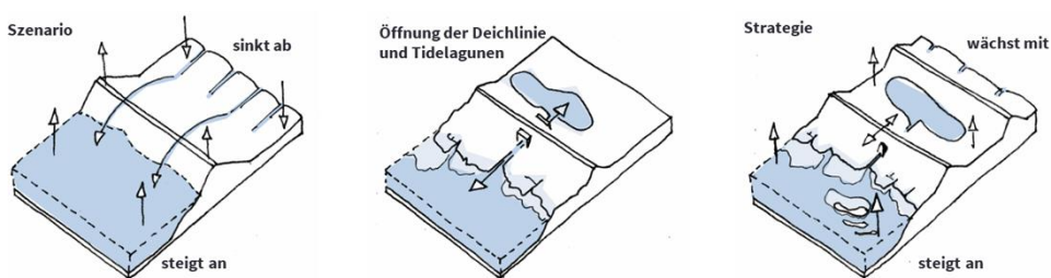
Abbildung 19: Natürlicher Küstenschutz am Wattenmeer: Die Marsch wird durch Deichöffnung geflutet, Sedimente lagern sich ab und die Marsch hebt sich an; es entsteht eine Tidelage. Die dahinter liegende Landschaft wird mit einer zweiten Deichlinie geschützt. Quelle: studio urbane landschaften - hamburg (Antje Stokman, Sabine Rabe)/UMO, 2010 (abgewandelt).
