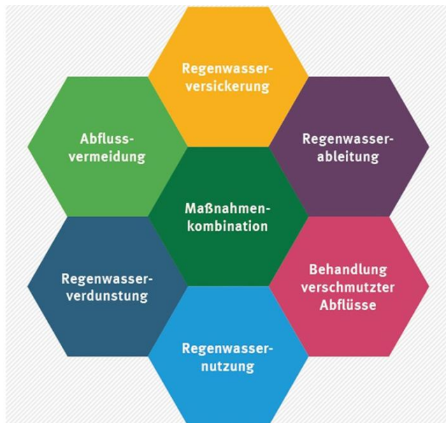
Abbildung 21: Maßnahmen für die naturnahe Regenwasserbewirtschaftung. Quelle: UBA, 2019d.
