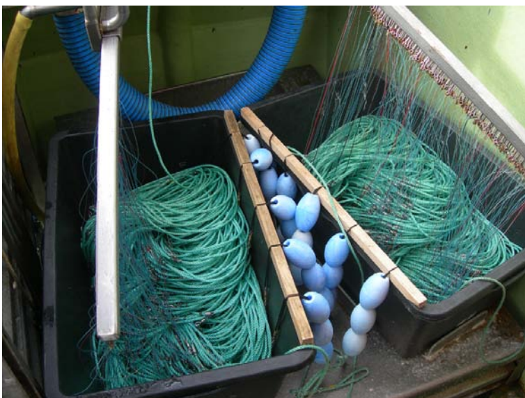
Abbildung 17: PVC-Auftriebskörper an zwei Hakenmagazine vor dem Setzen (Foto: NABU/K.Detloff)
