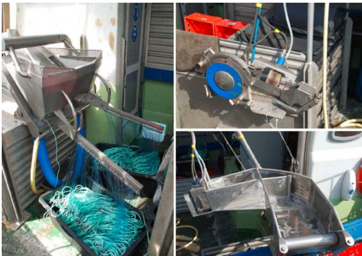
Abbildung 10: Aufbau des Langleinensystems an Bord des Kutters „Jan-Bella“: links Beköderer mit zwei Hakenmagazinen, rechts oben hydraulischer Leinenholer, rechts unten Färöerrolle und Leinenführung mit Hakenlöser (Fotos: NABU/K.Detloff).
