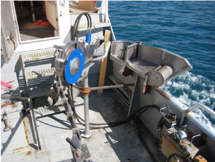
Abbildung 4: Automatisches Langleinensystem des Herstellers Oilwind (Foto: Oilwind)
